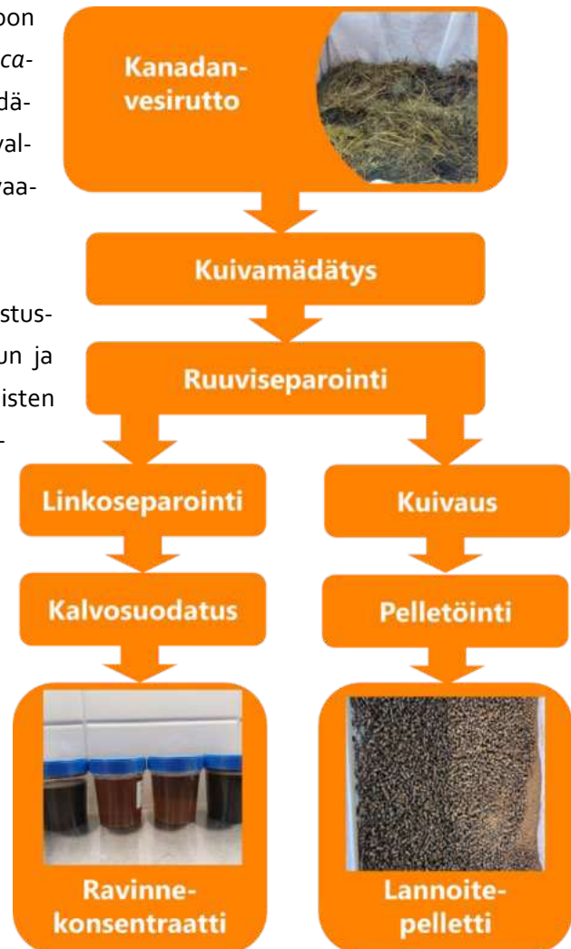
Kanadanvesiruton prosessointiketju neste- ja kuivajakeille Biopajan koelaboratoriossa.
