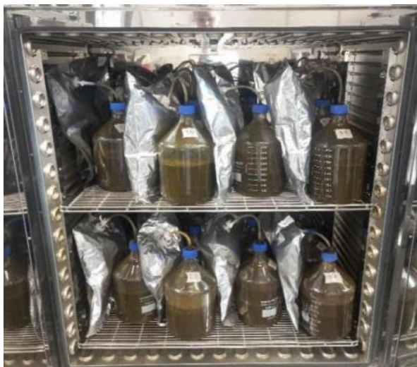
Kuva 5 Biokaasupanoskokeet toteutettiin viiden litran säilöpulloissa
