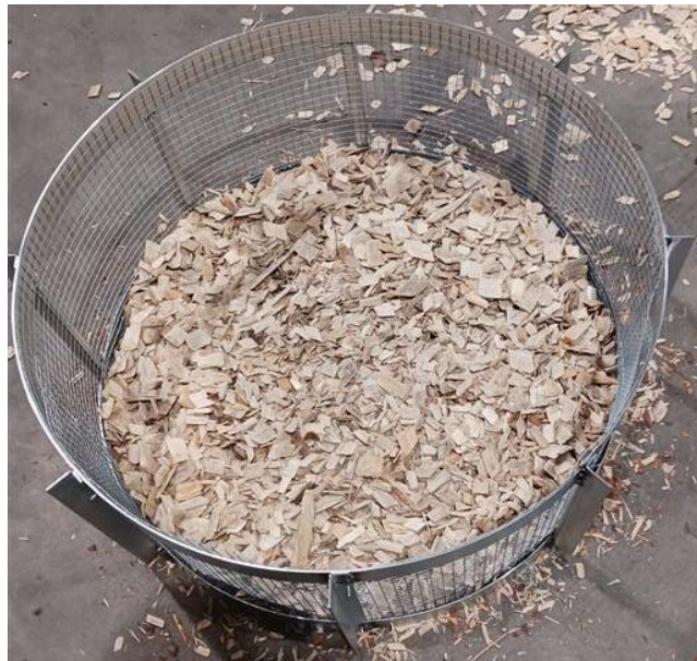
Kuva 7. Jakeet pakattiin kolmessa samanlaisessa korissa pyrolysointilaitteistoon.
