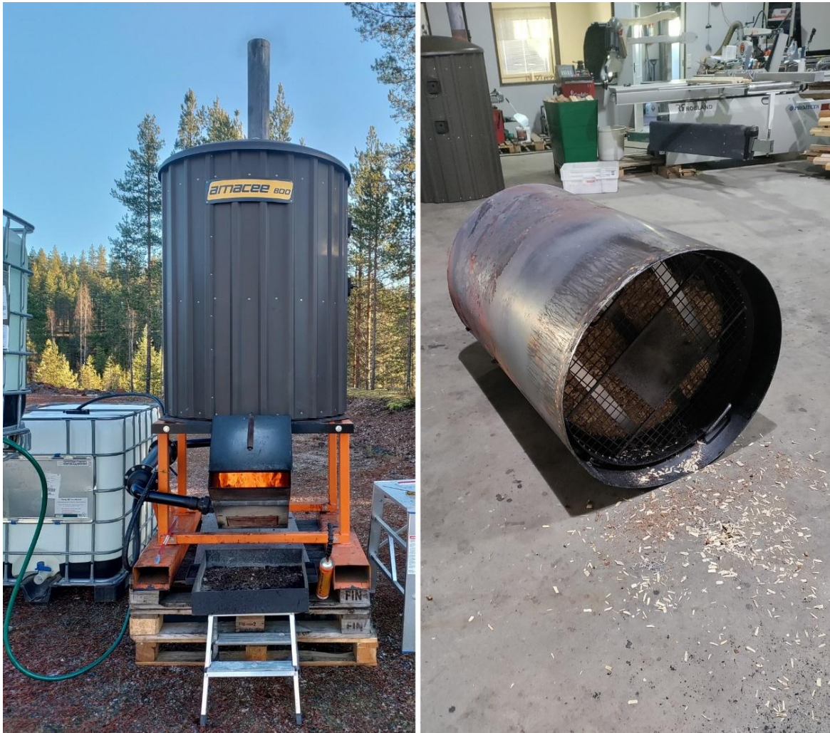
Kuva 6. Amacee 800 -laitteisto ja korien pakkaaminen laitteistoon.
